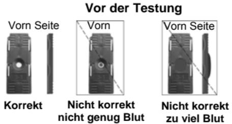
Nach dem Zugeben der Probe kontrollieren, ob das Probenfeld vollständig bedeckt ist. Das Probenfeld muss während des gesamten Tests bedeckt bleiben. Wenn das Probenfeld nicht oder von zu viel Blut bedeckt ist, den Test mit einer neuen Kartusche wiederholen.
