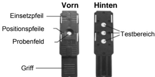
Folgende Testkartuschen sind erhältlich: CHOL Gesamtcholesterin, HDL Lipoprotein mit hoher Dichte, TRIG Triglyceride und 3-1 Lipid-Panel.
