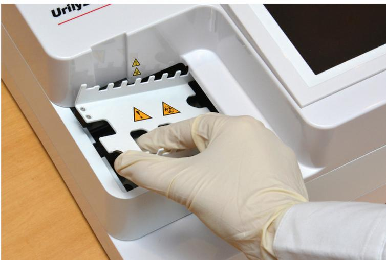
Abbildung 9: Einlegen des Transportkamms
