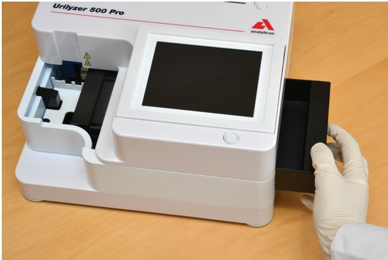
Abbildung 10: Einlegen des Teststreifenhalters/ Abfallbehälters
