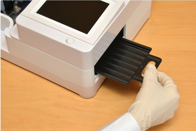
Abbildung 8: Einlegen des Tropfschutzes
