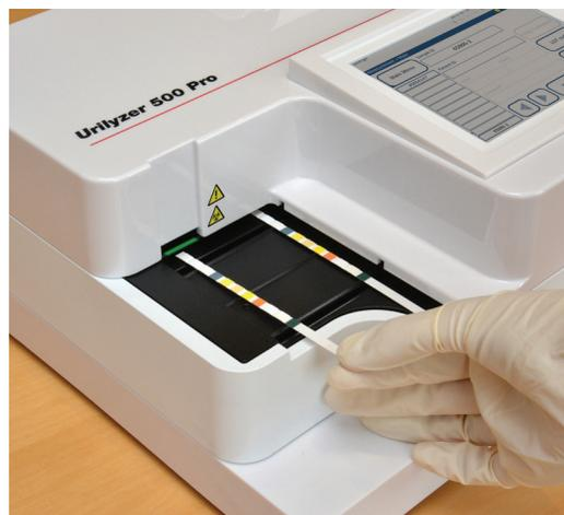
3. Den Teststreifen seitlich auf einem Papiertuch abtupfen, um überschüssigen Urin zu entfernen.
