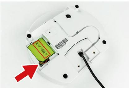
5. Legen Sie den Akku mit der Schrift nach oben und dem Anschlusskabel nach links ein. Setzen Sie zuerst den Akku ein und verlegen Sie das Kabel vorsichtig in der Aussparung unten
