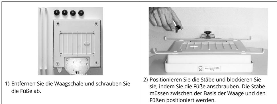
1) Entfernen Sie die Waagschale und schrauben Sie die Füße ab.
