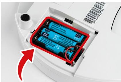
5. Setzen Sie zuerst den Alkalibatteriebehälter ein und verlegen Sie das Kabel vorsichtig in der Aussparung unten
