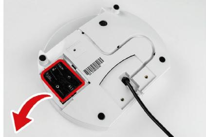
2. Entfernen Sie den Alkalibatteriebehälter vorsichtig
