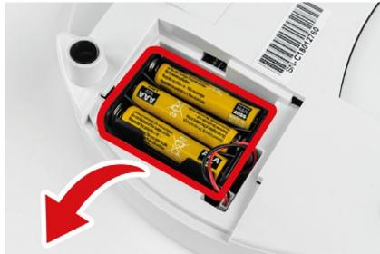
2. Entfernen Sie den Alkalibatteriebehälter vorsichtig
