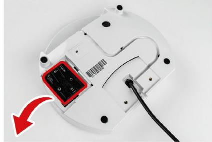
2. Entfernen Sie den Alkalibatteriebehälter vorsichtig
