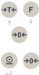
Gewünschte Funktion mit der Tara- oder Funktions-taste auswählen und mit der Druck-Taste übernehmen.
