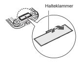
2. Legen Sie die Batterien so ein, dass die Polarität den Markierungen im Batteriefach entspricht.
