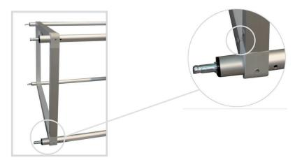
Montieren Sie die 4 Räder. Drücken Sie sie, bis sie hörbar einrasten.
