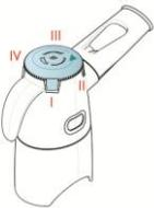
**Geschwindigkeitsregler:** Durch Drehen des Reglers und Auswahl einer der 4 Positionen (I-II-III-IV) erhöht sich die Zerstäubungsgeschwindigkeit auf das Doppelte, wodurch der Partikeldurchmesser stabil und optimal bleibt.
