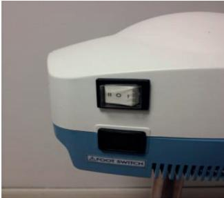
In der Nähe der Fußschalterbuchse ist ein Umschalter, der den Zweck hat, dasselbe Gerät direkt mit Stromnetzbetrieb oder durch die Fußschaltung laufen zu lassen.
