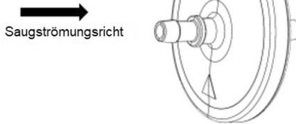
Sicherstellen, dass der Filter so angebracht ist, dass sich die Pfeile auf der Seite des Patienten befinden.
