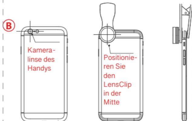
**Wenn Sie den LensClip verwenden:** **1)** Je nach Handymodell kann das Blitzlicht blockiert sein. **2)** Für optimale Ergebnisse entfernen Sie die Handyhülle, wenn vorhanden. **3)** Wenn Sie die Makrolinse verwenden, beträgt die optimale Entfernung zum Gegenstand 0,4 - 0,8 Inches
