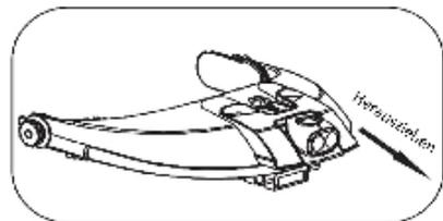
Drücken Sie mit dem Finger auf zwei konvexe Stellen an der Lichtquellenbox, dann ziehen Sie die Lichtquellenbox leicht heraus;
