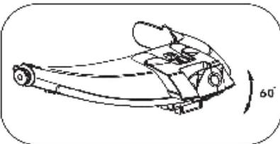
Jetzt kann der LED-Lichthalter nach oben und unten gedreht werden;
