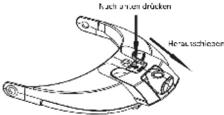
Drücken Sie die mit PUSH markierte Klappe nach unten und schieben Sie die Lichtquellenbox heraus
