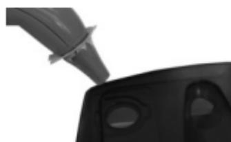
Schieben Sie die Sonde zur Gänze in das Loch des Schutzhüllenhalters.
