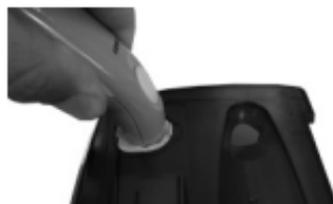
Nehmen Sie das Gerät und führen Sie die Sonde vertikal in den Mittelteil der Schutzhülle ein.
