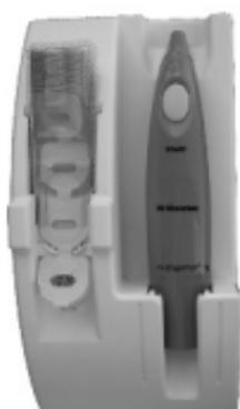
Setzen Sie einen Sondenhüllenbehälter in das ri-former Ausbaumodul ein.
