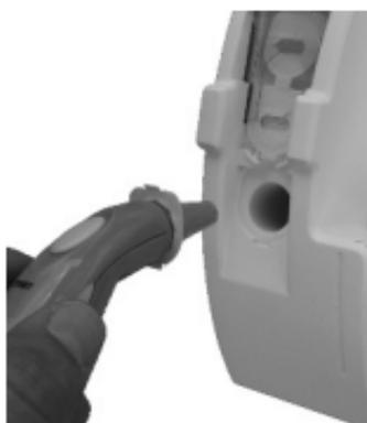
Drücken Sie die Sonde bis zum Anschlag in die Sondenhüllenaufnahme.
