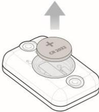
3. Richten Sie die Batterie mit dem Pluspol nach oben aus, so dass die Aufschrift zu sehen ist. Entfernen Sie den Schutzaufkleber von der Batterie, falls vorhanden.
