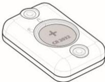
4. Schließen Sie die Batteriefachabdeckung; beachten Sie, dass die Batteriefachabdeckung nur in einer Richtung eingesetzt werden kann und gedreht werden muss.
