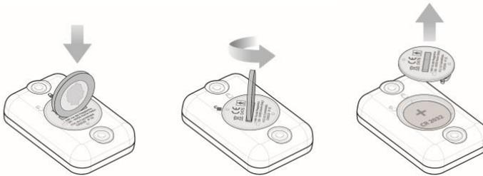
2. Entfernen Sie die entladene Batterie und ersetzen Sie sie durch eine neue Knopfzellenbatterie Typ 3V CR2032.
