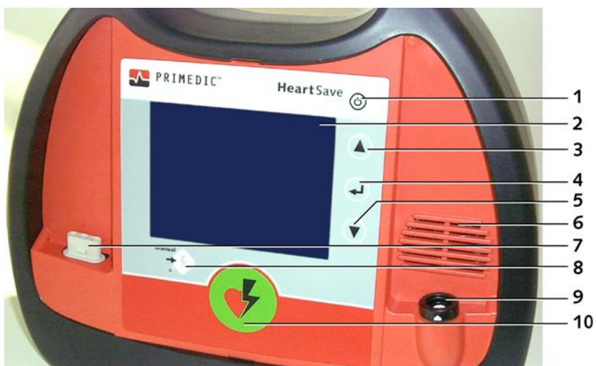
Abb. 4: PRIMEDIC™ HeartSave 6/6S Bedienelemente
