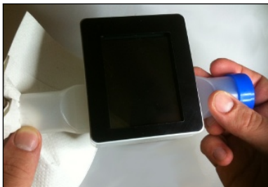
Reinigen die äußeren Perimeter mit Desinfektionsmittel
