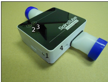
Bedienelemente des Geräts: 1. An/aus Schalter 2.Drahtlos (Wireless) -Aktivitäts-LED 3. Batterie-LED 4. USB-Kabel und Ladegerät
