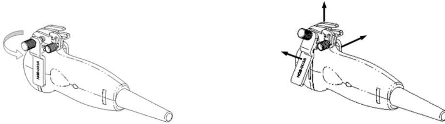
(3) Lösen Sie die Sicherungsmutter der Klammer, und entfernen Sie die nadelgeführte Klammer vom Schallkopf.
