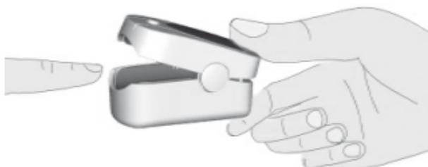
Abbildung 3 Den Finger in das Oximeter einführen
