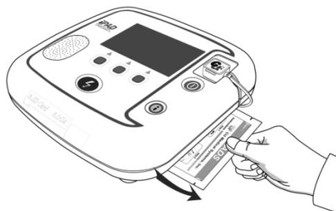
3. Stecken Sie den Elektrodenanschluss der neuen Elektroden am Defibrillator ein und schieben Sie dann die Elektrodenpackung in das Aufbewahrungsfach. Siehe Abbildung unten.
