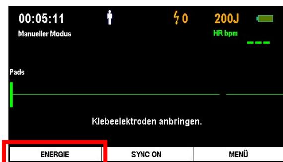
Sobald Sie die Softtaste 1 drücken, wird der Wert für die Abgabeenergie in der rechten oberen Ecke des LCD-Bildschirms weiß hervorgehoben. Zudem werden die Softtasten mit folgenden Funktionen belegt:
