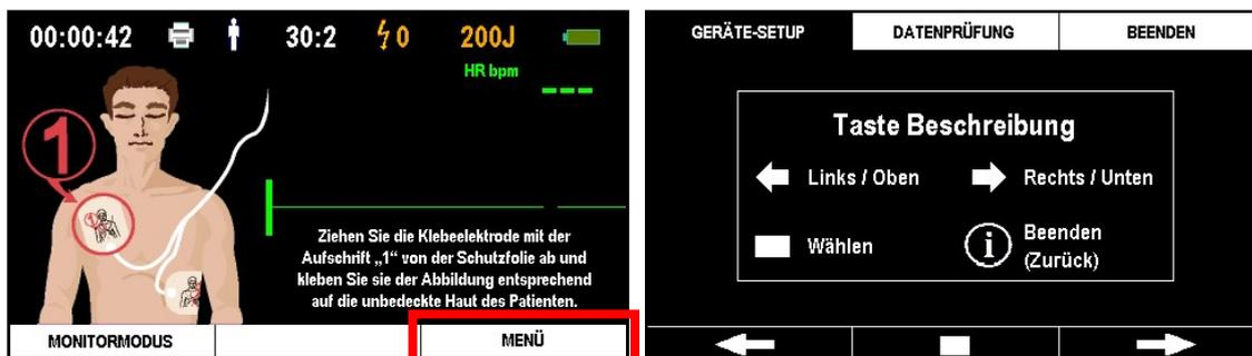
Im Menümodus wird zuerst die Seite mit den Tastenbeschreibungen angezeigt. Zum Schließen dieses Fensters können Sie eine der drei Softtasten drücken. Anhand der drei Tasten können Sie im Menümodus die Gerätebedienung und die HLW-Anweisung einstellen sowie die gespeicherten Behandlungsdaten überprüfen.
