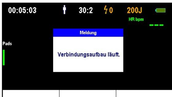
Nach dem Verbindungsaufbau wechselt das Gerät in den Monitormodus, empfängt EKG-Daten vom CU-EM1 und zeigt die Daten auf dem LCD-Bildschirm an.
