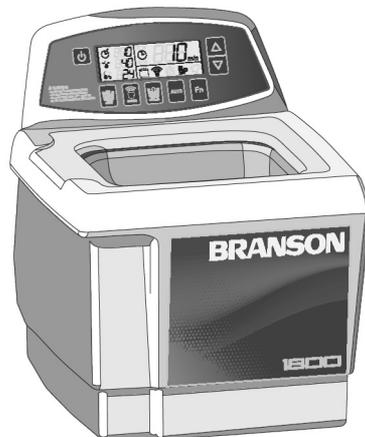
Zum ersten Befüllen oder nach dem Wiederbefüllen mit frischem Wasser sollte warmes Wasser eingesetzt werden. Nach dem Einschalten der Heizung (falls vorhanden) und des Ultraschalls (Betätigung der Taste "SONICS", oder Drehen des Timers) wird die Flüssigkeit zügig aufgeheizt. Während dieser Phase sollte die Abdeckung zur Wärmeisolierung aufgelegt werden.
