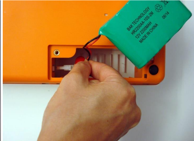
2. Den Batterieverbindungsstecker abtrennen.
