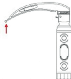
Abb. 3) Heben Sie die Spatel gerade nach oben, bis sie mit dem Griff einrastet
