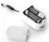
Figur 3. Installation af batterier
