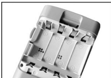
Gire el medidor y ubique la cubierta de las pilas, situada en su parte trasera. Abra la cubierta presionando la lengüeta de la cubierta marcada con una flecha. Presione la lengüeta hacia la parte inferior del medidor para sacar la cubierta y acceder al compartimento de las pilas.
