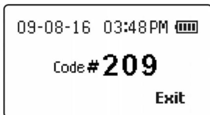
Si no hay un chip codificado en el medidor cuando se inserta una tira reactiva o el chip codificado da error, aparecerá la siguiente pantalla.
