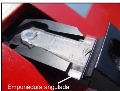
Figura 16 - Cubeta colocada incorrectamente
