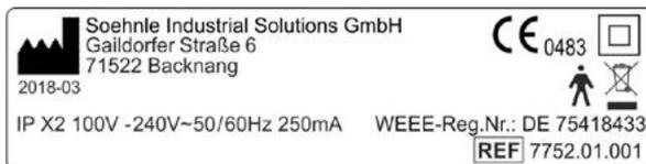
La ilustración muestra un ejemplo de una placa de identificación en la báscula para bebés 7752.
