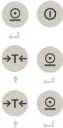
Pulse y, a continuación, junto con la tecla ON/OFF durante 5 segundos hasta que aparezca UCAL 1.
