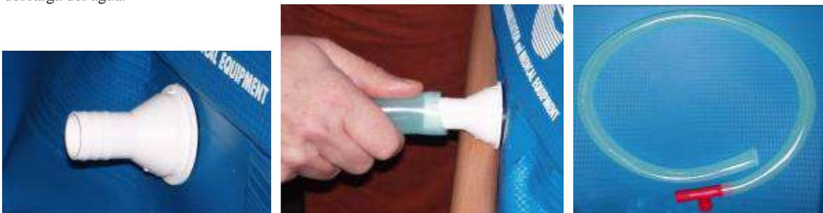
El conector en T rojo sirve para juntar los tubos y descargar el agua desde un único punto.
