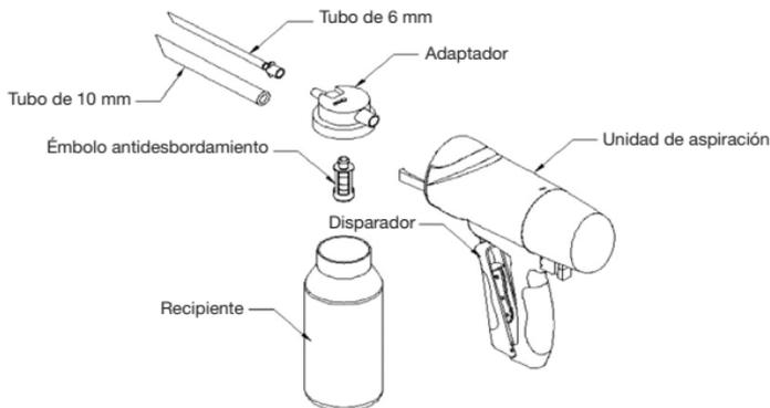
2. Conecte el adaptador con el tubo a la tapa del recipiente. El recipiente debería estar conectado a la bomba.
