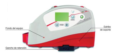
Una vez terminada la introducción del aspirador en el estribo de soporte, asegúrese de la recarga en curso, comprobando la señalización de la pantalla LCD en la parte frontal del dispositivo, como en las TAB.I y TAB.II
