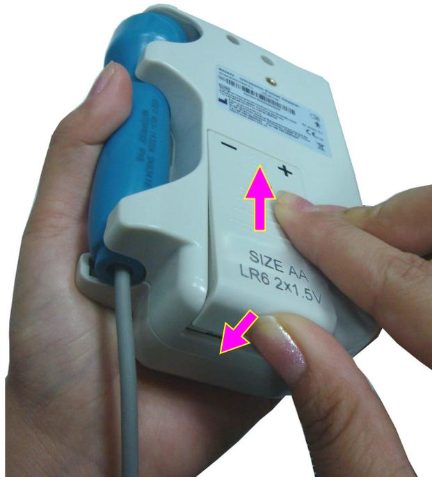
Figura 3-3 Cierre del compartimento para pilas
