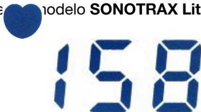
Si el sistema Doppler funciona en el modo 1, el valor numérico se corresponde con la frecuencia cardíaca en tiempo real y cambia continuamente.
