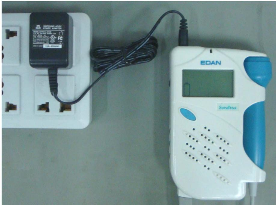
Figura 3-7 Recarga del paquete de pilas de NI-MH
