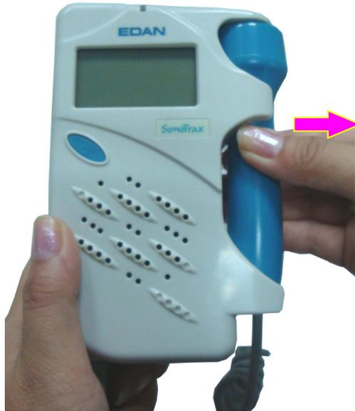
Figura 3-4 Retirada de la sonda
