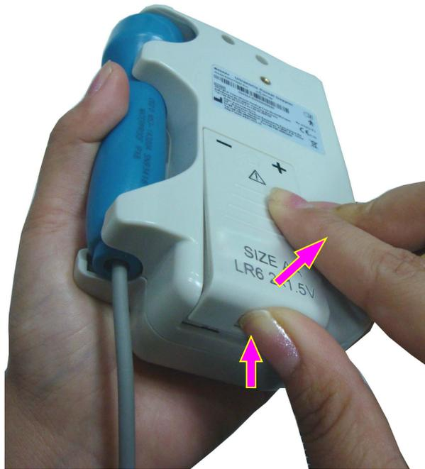
Figura 3-1 Apertura del compartimento para pilas
