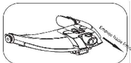
Presione dos puntos cóncavos en la caja de luz con el dedo, luego saque la caja de luz ligeramente;
