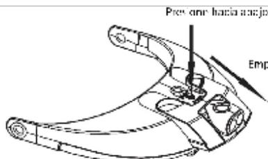
Presione hacia abajo la hebilla marcada con el símbolo EMPUJAR, empuje la caja de luz hacia afuera
