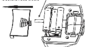
La fuga de la batería, el calentamiento y el agrietamiento son unas de las razones que causan el mal funcionamiento y el daño del LED;
