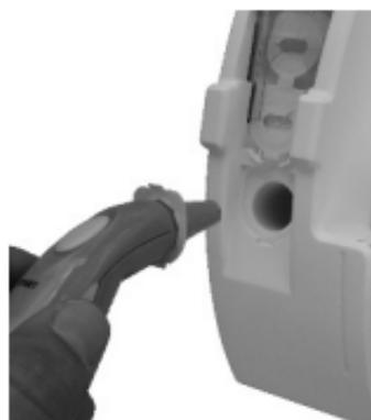
Introduzca la sonda totalmente en el orificio de soporte del casquillo de sonda.
