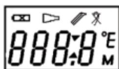
2. El valor de la última medición es mostrado en el display automáticamente durante 2 segundos junto con el símbolo «M».
