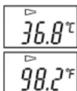
El valor medido aparecerá en la pantalla LCD con el símbolo °C o °F parpadeando, el aparato está listo para la próxima medición. Un icono de oído cruzado
