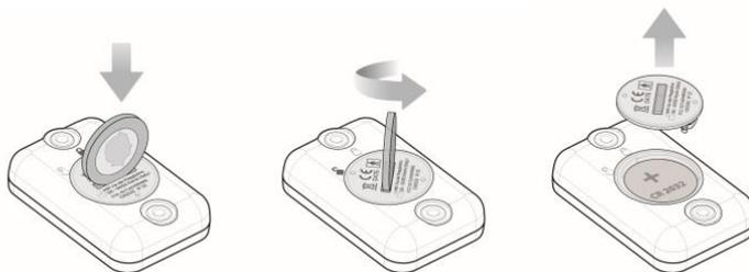
2. Retire la pila usada y sustitúyala por una nueva pila de botón CR2032 de 3V.
