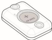
4. Cierre la tapa del compartimento de la pila; tenga en cuenta que la tapa del compartimento de la pila puede introducirse solo en un sentido y debe girarse.
