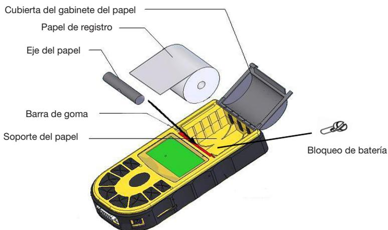
1. El instrumento utiliza papel de grabación envolvente de una vía de 50mm.
