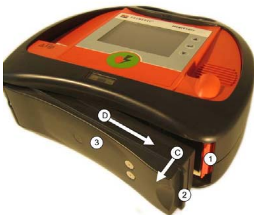
Fig. 11: Extracción del módulo de energía
