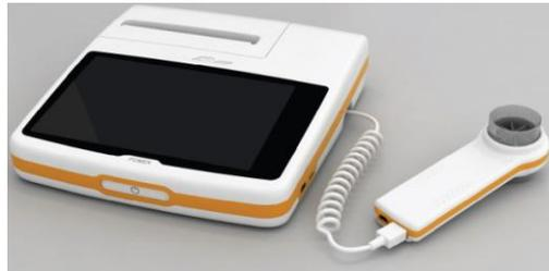
El dispositivo está diseñado para medir los parámetros de respiración, para monitorizar la saturación de oxígeno y la frecuencia del pulso. Además de efectuar una prueba de control para determinar la calidad de las lecturas realizadas, el dispositivo puede guardar los resultados de cerca de 10.000 espirometrías o de un máximo de 900 horas de datos de oximetría.
