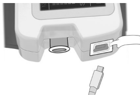
Figura 5.16 Croquis para la conexión entre el medidor de pantalla de apnea del Sueño y la línea de datos USB
