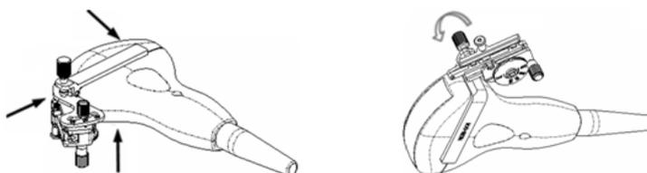
3. Enrosque la tuerca de fijación del soporte guía para aguja para asegurarse de que dicho soporte esté correctamente instalado en el transductor.
