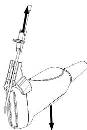
3) Retire la sujeción del soporte guía para aguja del transductor.
