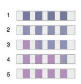
Posición 1: Tira indicadora no tratada (color indicador químico original) Posición 2: Baja temperatura / tiempo de retención breve o ausencia de vapor Posición 3: Típico para problema de fugas o de vacío Posición 4: Típico para problema de gas
