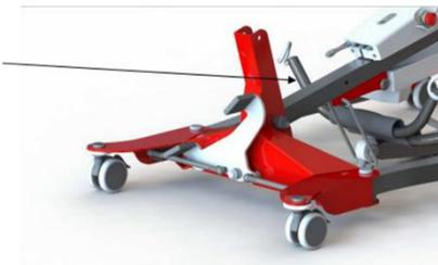
2. Retire el perno de bloqueo y eleve el bastidor principal hasta que alcance el enchufe de la base.
