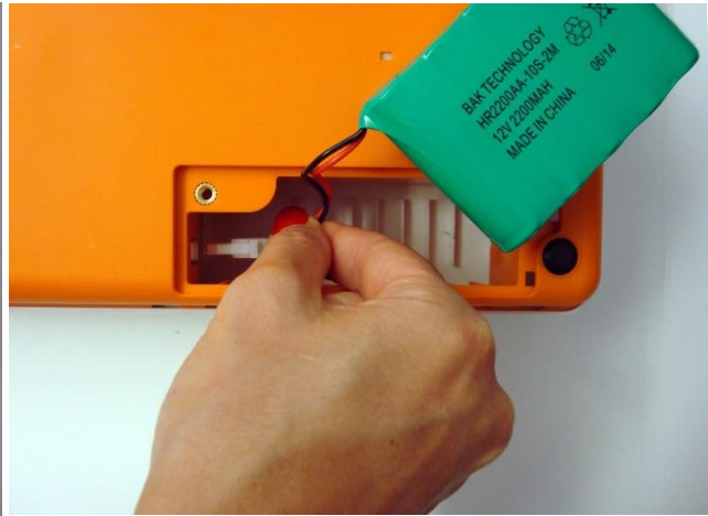
2. Desconecte el conector de la batería.
