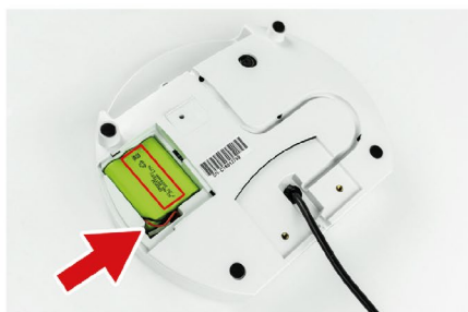
5. Aseta paristot paikalleen siten, että merkinnät osoittavat ylöspäin ja liitäntäkaapeli vasemmalle. Aseta paristot ensin paikalleen ja aseta sitten kaapeli varovasti pohjassa olevaan syvennykseen
