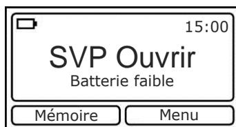
Le symbole de la batterie indique la capacité restante. L'appareil affiche l'avertissement « Batterie faible » lorsque la capacité est faible. Si la batterie n'est pas rechargée, l'appareil s'arrête peu après cet avertissement.
