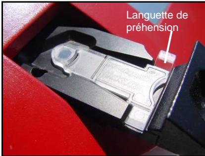
Figure 12 – Cuvette bien positionnée
