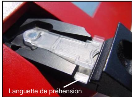
Figure 13 - Cuvette mal positionnée
