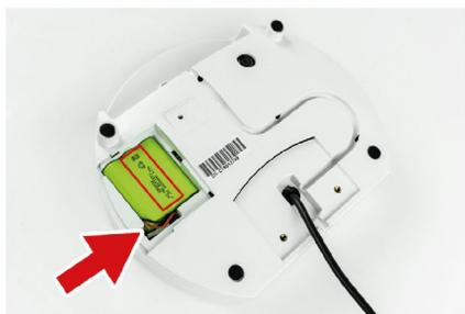
5. Insérez la batterie avec l'écriture vers le haut et le câble du connecteur vers la gauche. Insérez d'abord la batterie, puis disposez soigneusement le câble dans le logement en bas
