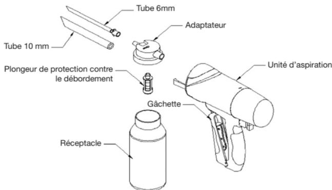
2. Fixer l'adaptateur avec la tubulure sur le bouchon du réceptacle.
