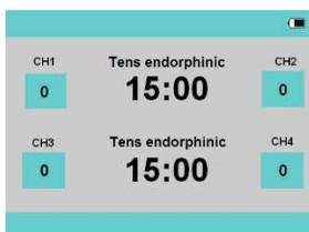
En utilisant les touches de sélection **[▼]** et **[▲]** il est possible de mettre en évidence le programme que l'on souhaite modifier (le nom du programme devient blanc) et on accède de nouveau à la liste des programmes où l'on peut choisir un programme différent. La barre d'état indique les canaux (CH1+CH2) ou (CH3+CH4) pour lesquels on est en train d'effectuer la variation de programme.
