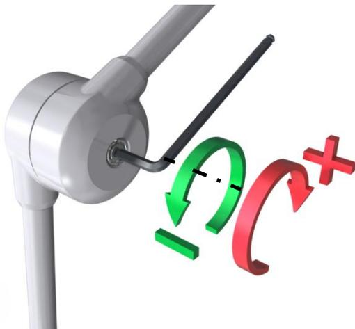
Retirez l'autocollant pour accéder à l'articulation touchée. À l'aide d'une clé hexagonale, utilisez la vis de réglage sur le côté de l'articulation.
