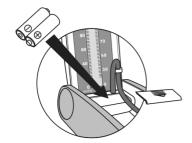
2 Ouvrez le couvercle du compartiment des piles, chargez les piles correctement et refermez ce couvercle.
