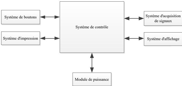
Figure 4-1 Schéma fonctionnel de l'unité de commande
